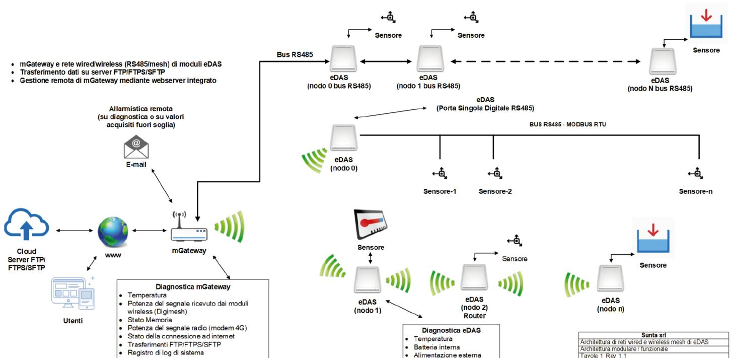
4. mGATEWAY-WIRELESS: Include il modulo radio per le reti di datalogger wireless (Digimesh®/LORAWAN®)
