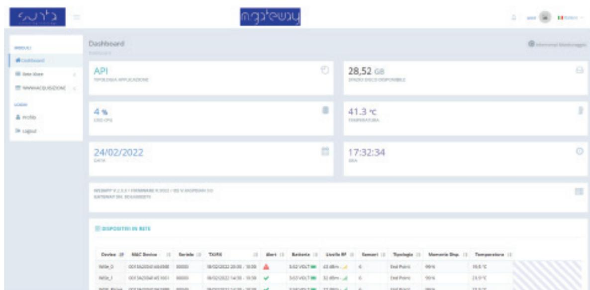
Su ogni singolo datalogger della rete di mGateway è possibile configurare soglie di allarme e la relativa azione di invio SMS/e-Mail a diversi utenti. La diagnostica locale permette il monitoraggio delle risorse di mGateway come i parametri relativi alla memoria alla CPU, valori fisici come la temperatura e di batteria di ogni nodo della rete.
