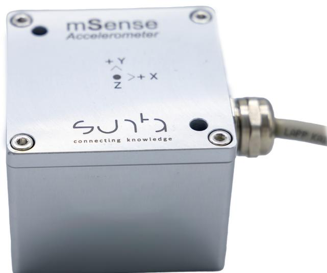
Fig. 1 - Accelerometro triassiale mSENSE
